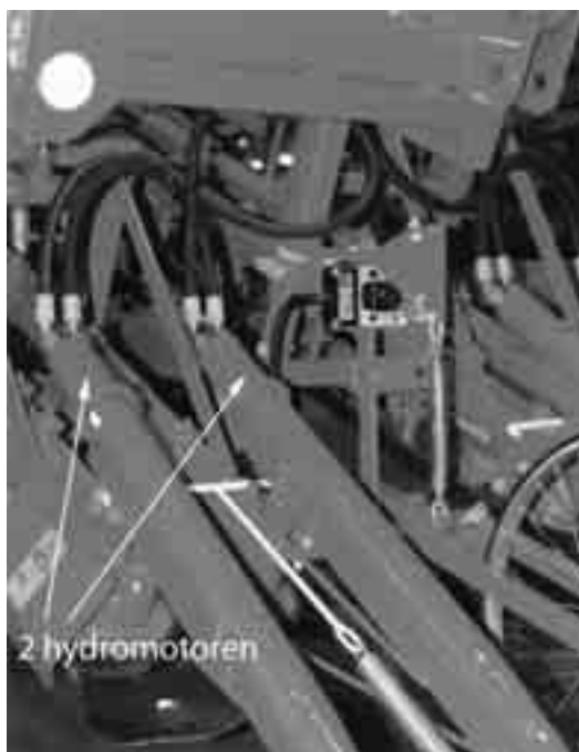
Fig. 6.7 Met een hydraulische aandrijving zijn de toerentallen van de torpedo's traploos regelbaar.
