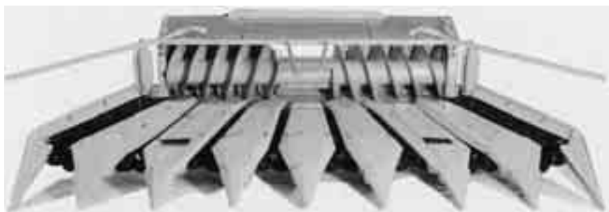
Fig. 3.5 Een voorzetstuk met kettinginvoer is rijafhankelijk.
