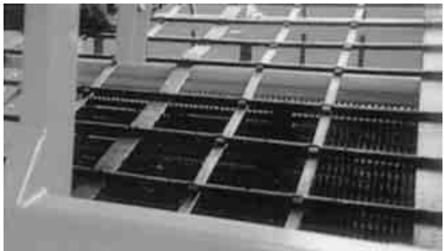
Fig. 5.16 De aardappels vallen door de mazen, het loof niet.
