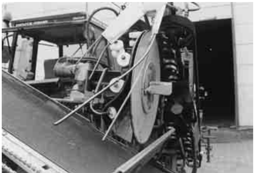
Fig. 6.16 Aan het eind van de klembanden nemen een metalen en een rubberen schijf de prei over en leggen ze netjes op de afvoerband.
