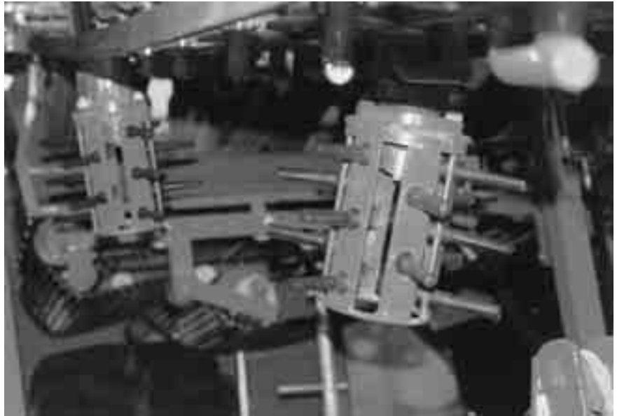
Fig. 6.3 Rubberen vingers verwijderen de grond van de wortels.
