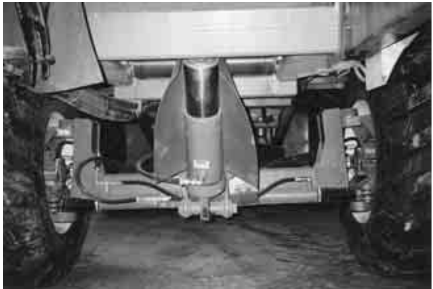
Fig. 7.11 Het nivelleren van de erwtenplukdorser
