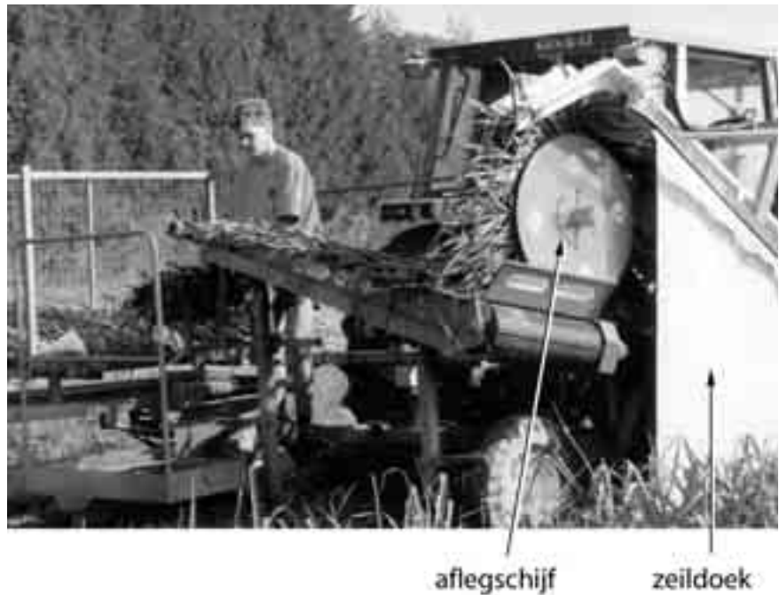
Fig. 6.12 Het gerooide product wordt in rekken gestapeld.
