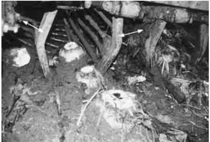
Fig. 2.6 Zelfzoekende, aangedreven rooischaren volgen de bietenrij.
