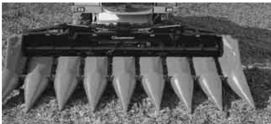
Fig. 1.29 Het plukvoorzetstuk heeft lange punten (torpedo's) die tussen de maïsrijen doorlopen.
