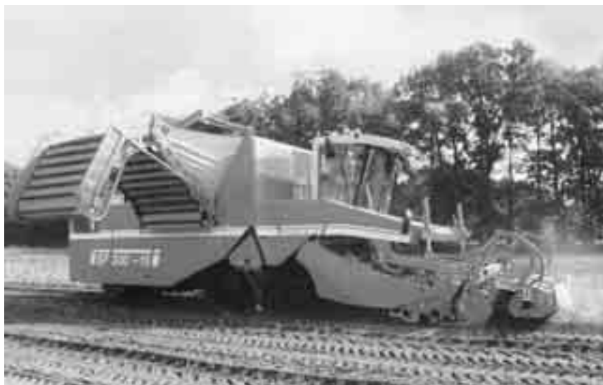
Fig. 5.1 Vierrijige 15-tons bunkerrooier op rupsen
