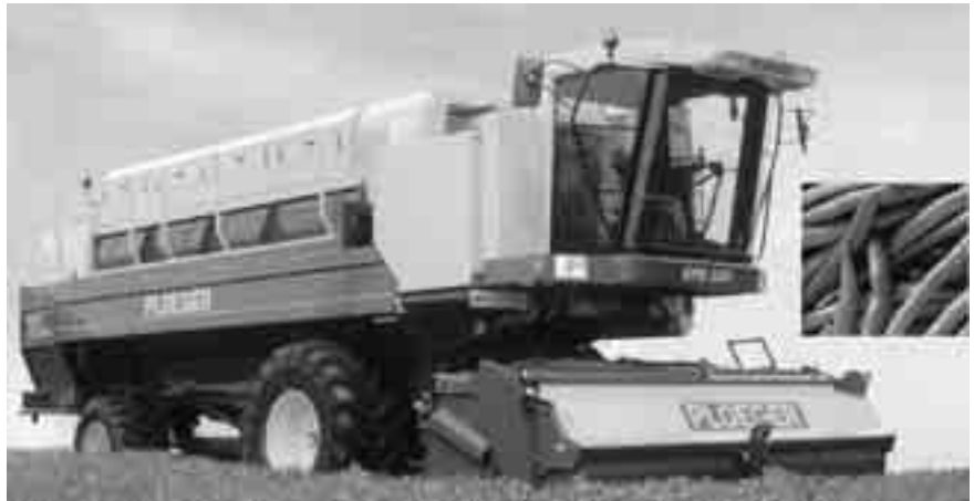
Fig. 7.14 Bonen pluk je met een bonenplukmachine.
