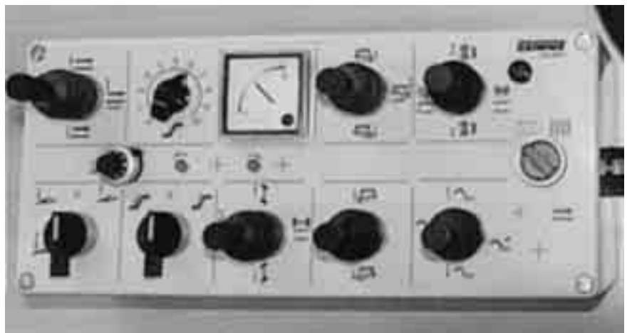
Fig. 5.22 De bedieningskast van een getrokken aardappelrooier
