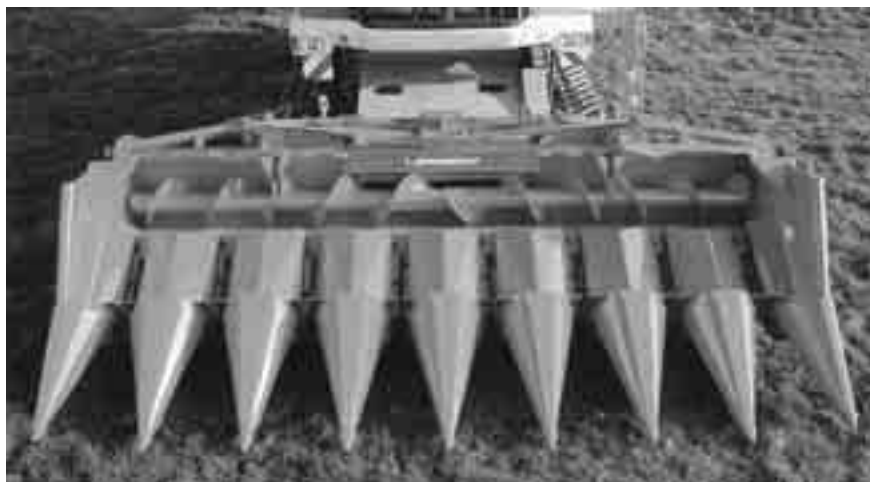
Fig. 3.4 Om maïskolvenschroot te maken, gebruik je een kolvenplukker.
