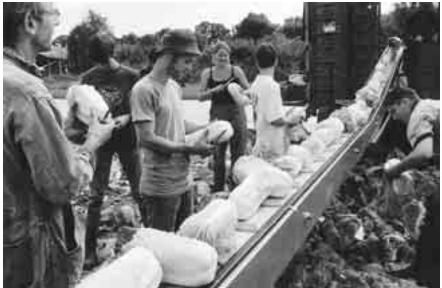
Fig. 8.11 Oogstbanden zijn lange transportbanden waarop de groenten verzameld worden.
