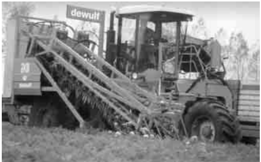
Fig. 6.1 De wortels hangen aan het loof terwijl ze omhoog gebracht worden.
