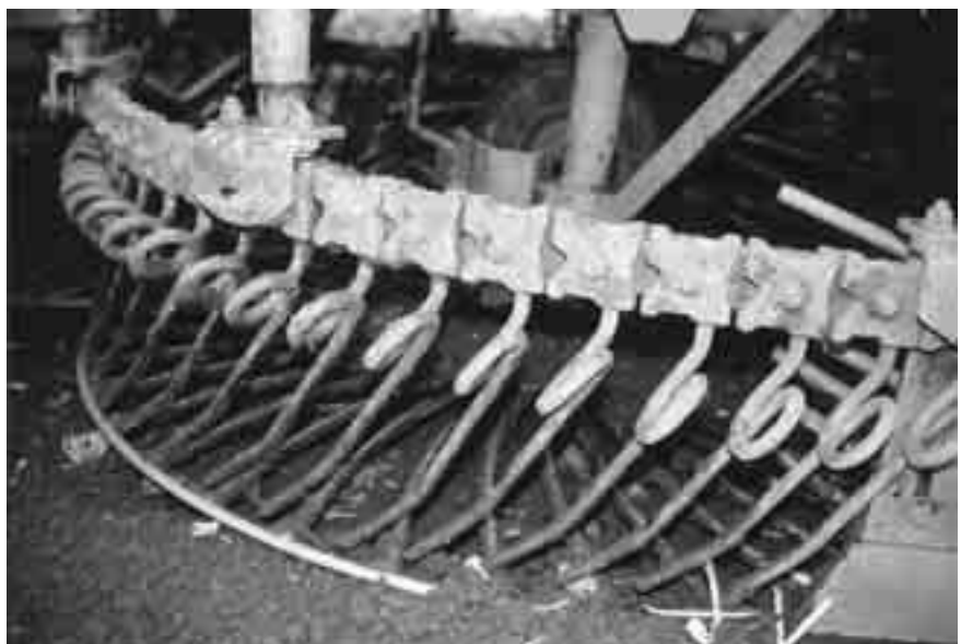
Fig. 2.8 Zeefraderen met verticale veertanden reinigen intensief.
