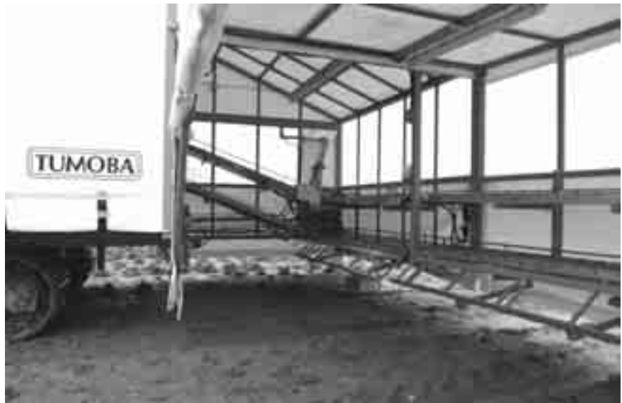
Fig. 8.12 Een mobiel verpakkingsstation bestaat uit een rupsonderstel met een oogstplatform.
