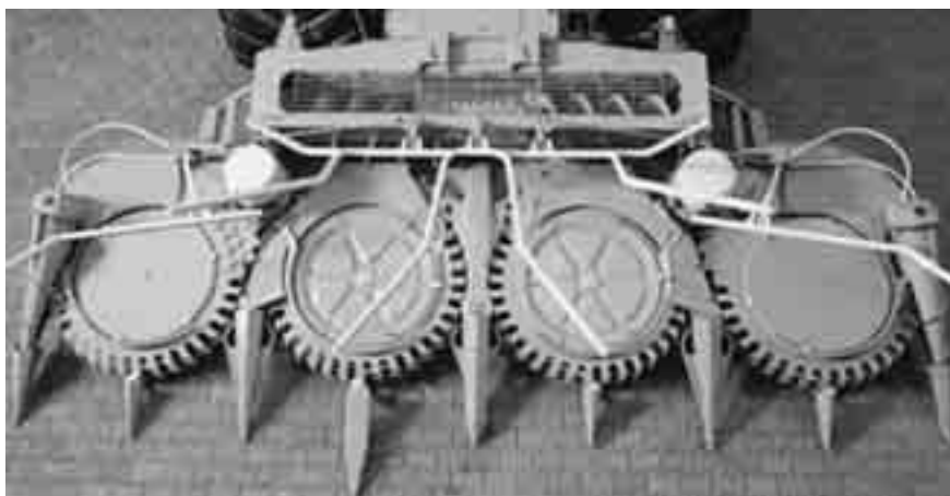
Fig. 3.7 Een voorzetstuk met roterende trommels is rijonafhankelijk.
